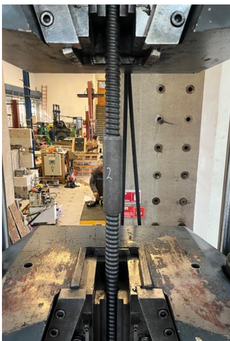
Fotografía 3.1. Montaje tipo para conjunto barra – conector.
