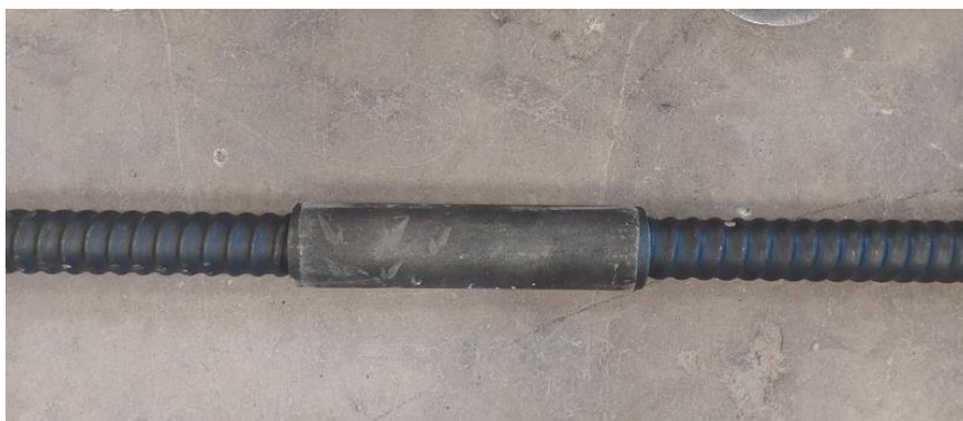
Fotografía 2.1. Barras con Conector mecánico cilíndrico
