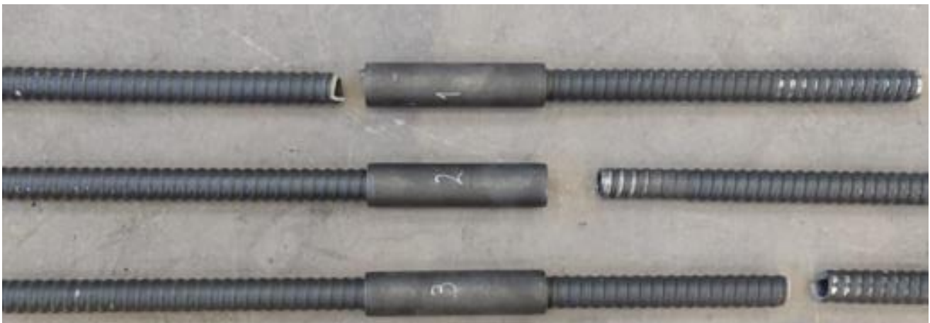
Fotografía 5.1. Modo de falla de muestras del conjunto barra – conector. Barra auto perforante \phi 38 mm (R38)
