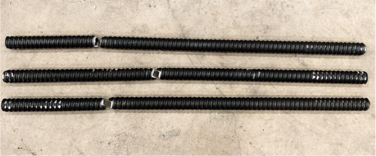
Fotografía 6.1. Modo de falla de probetas de la barra autoperforante \varnothing 38 mm (R38N/21).
