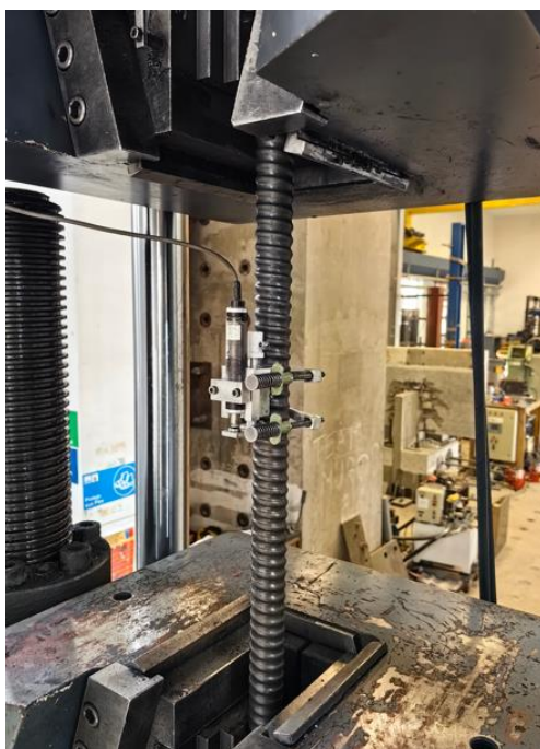
Fotografía 3.1. Montaje tipo para ensayo de tracción de barra autopercutor de acero.
